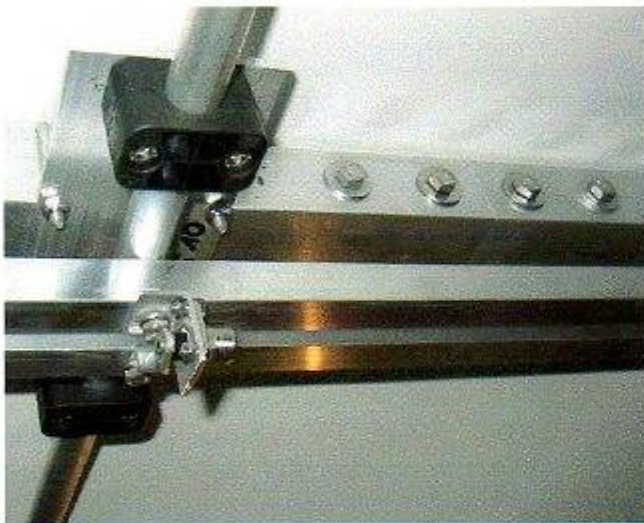
Ansicht Koax-Anschlußbuchse SO239 mit Strahler- element und Phasenleitung / view coax connector SO239 with driven element and phaseline
