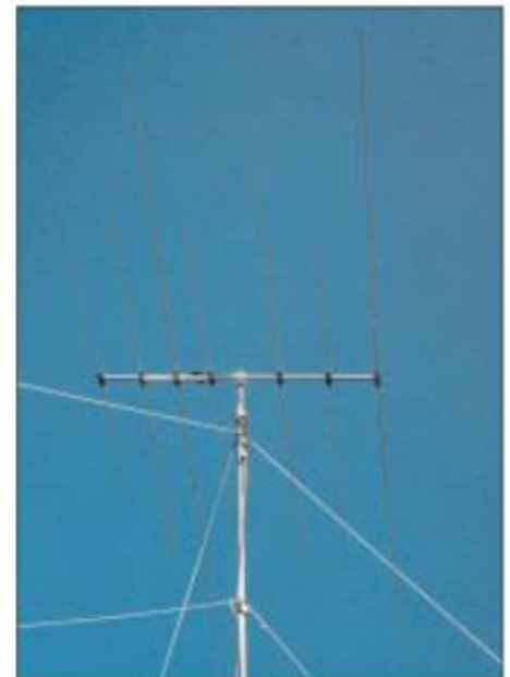
Bild 2: Der OB7-3 in voller Pracht. Er befindet sich ungefähr 18 m hoch über Grund.
