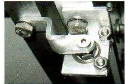
Ansicht Koax-Anschlußbuchse SO239 mit Strahler- element und Phasenleitung / view coax connector SO239 with driven element and phaseline
